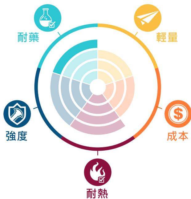
PPS是增強、內潤滑的半結晶體聚合物，它具有良好的化學和機械性能，在高溫下尺寸穩定性高，包括耐磨、高負荷能力和尺寸穩定性，它的開發縮小了一般標準塑膠材料與高階工程塑膠材料之間的性能價格差別。玻璃纖維的增強,因此具有極高強度的優點，並且保留優異的化學抵抗性能，更重要的是可有效的彌補一般PPS熱變形溫度過低的缺點。
